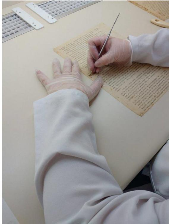
Remoção de sujidades com auxílio de pinça de metal, em mesa com mecanismo de sucção.
