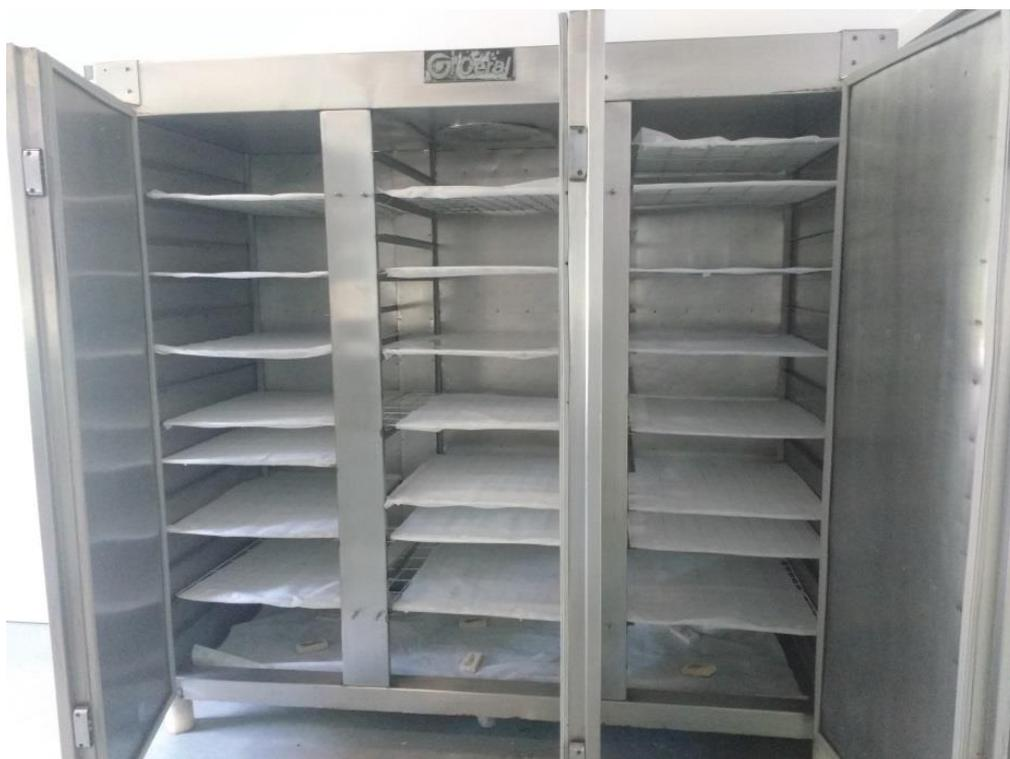
Câmara de fumigação adaptada de um antigo refrigerador existente em um depósito da Cia. Hering. Este refrigerador foi desinfetado, recebeu prateleiras e novas borrachas para vedar a entrada e saída de ar. Para seu funcionamento tivemos grande auxílio da equipe de manutenção da Cia. Hering.
